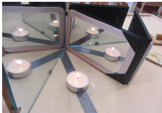
Рисунок 5 – Свеча и пять её изображений
