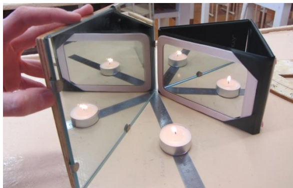
Рисунок 4 – Свеча и четыре её изображения
