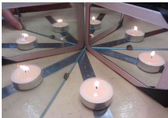
Рисунок 6 – Свеча и шесть её изображений
